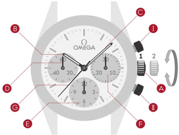
Заводная головка имеет 2 положения:
