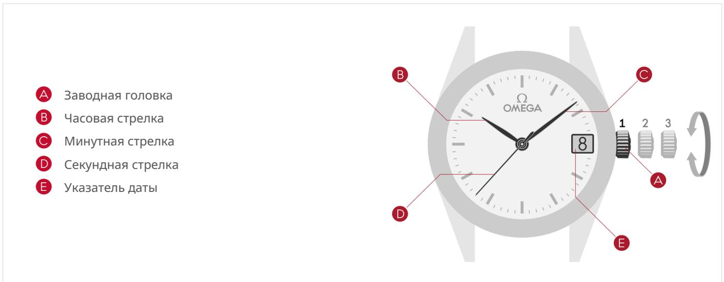
Заводная головка имеет 3 положения:
