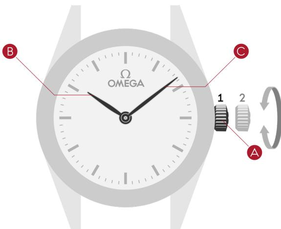
Заводная головка имеет 2 положения:
